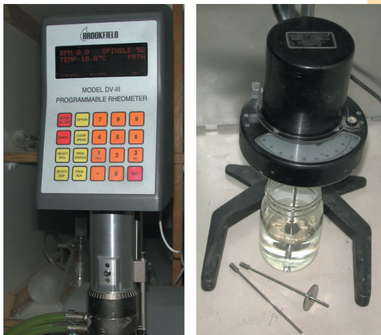
图12 两类粘度计：锥板粘度计（左图）和旋转粘度计（右图）。
