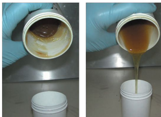
图11 高触变性的环氧固化剂。材料不会流动（左图），直至搅拌几秒钟后才流动（右图）。
