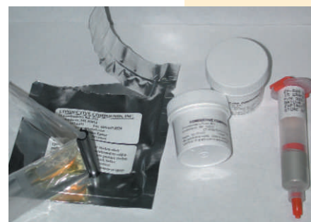
图3 双组分环氧胶粘剂的包装选项。从左到右：（a）塑料袋，装有已称量并且由一个可移除的塑料夹分隔的树脂和固化剂；（b）顶部可打开的塑料瓶，装有确切数量的树脂和固化剂，最终用户将固化剂加到树脂容器中使二者混合；（c）预混合/冷冻的注射器，必须在零下40摄氏度保存。
