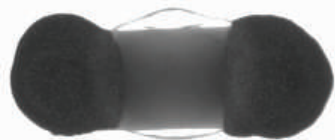
图11 在一个经过正确贴装的LED下方，两个发生迁移的环氧导电胶盘变形为椭圆（上图）；在两个胶盘的中心涂布一个非导电胶盘，再贴装相同的元件，可减少导电胶粘剂迁移（下图）。感谢美国宾夕法尼亚州的Nicomatic公司提供图片。
